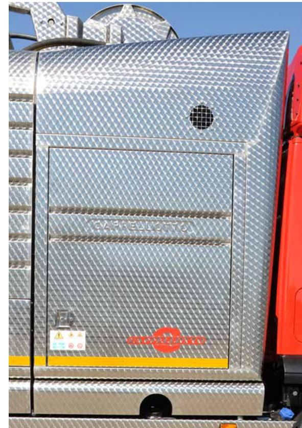
Защитный отсек для насосной группы идеально подогнан к кабине и разработан для обеспечения максимальной безопасности при эксплуатации.
