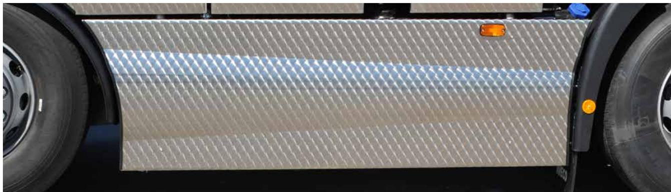
Боковые защитные панели выполнены из нержавеющей стали с обтекаемыми краями для повышения уровня безопасности.
