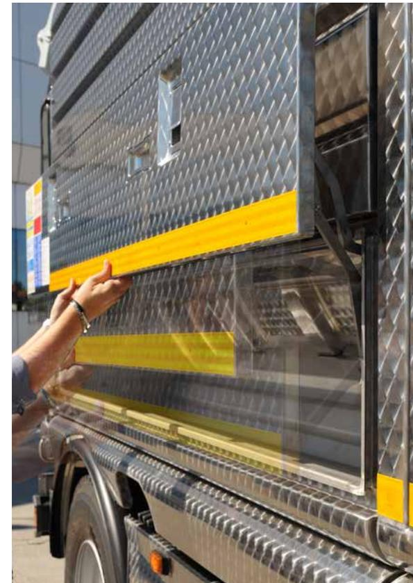
Герметичные пеналы для хранения шлангов с системой открывания дверей «крыло чайки».
